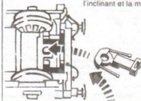
Kupplungsaufnahme 6575 schräg einführen und auf Zapfen stecken.
