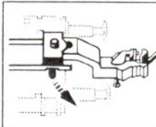
Das Halteblech befestigen. Die **Zapfenkupplung** ist montiert.
