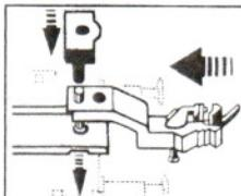
Die **Zapfenkupplung** in das Halteblech einrasten.
