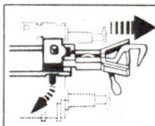
Halteblech der Kupplung lösen und **Zapfenkupplung** entfernen.
