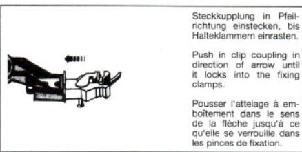
Steckkupplung in Pfeilrichtung einstecken, bis Halteklemmen einrasten.
