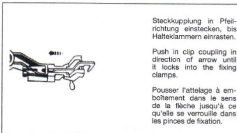
Steckkupplung in Pfeilrichtung einstecken, bis Halteklammern einrasten.
