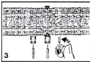
Posez les bornes avec les repères aux joints de rails. Appuyez sur la voie jusqu'à encliquetage.
